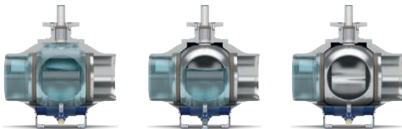
Abbildung 14. „Double Block & Bleed“ – Funktion
